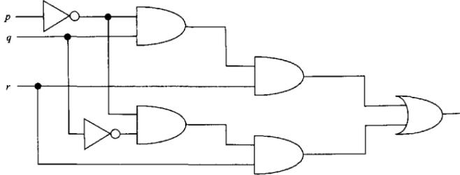
7. Выписать канонические уравнения для функций, которые реализуются данной схемой. Полученные функции упростить.
