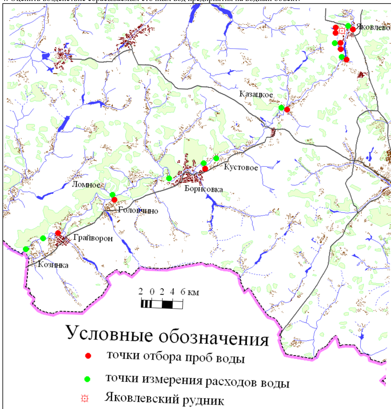
Рисунок 1 – Карта-схема отбора проб воды и измерения расходов воды
