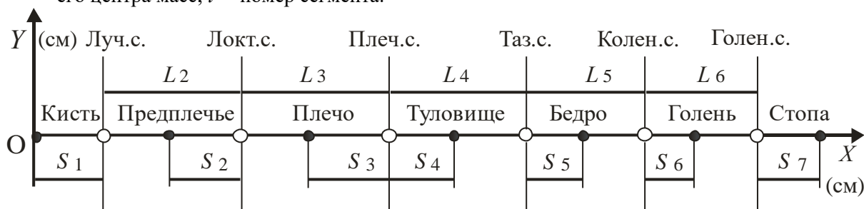
Рис. 5. Индексное обозначение расстояния от антропометрической точки сегмента до его центра масс ( S_i )
